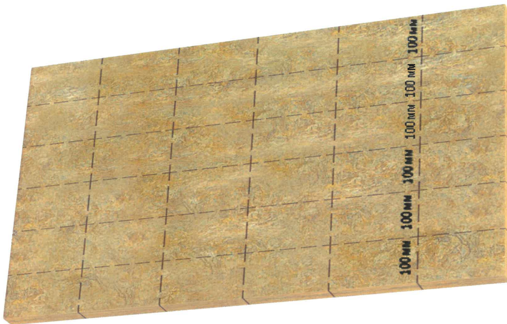
Рис. 1 Выкройка минераловатных вставок.
