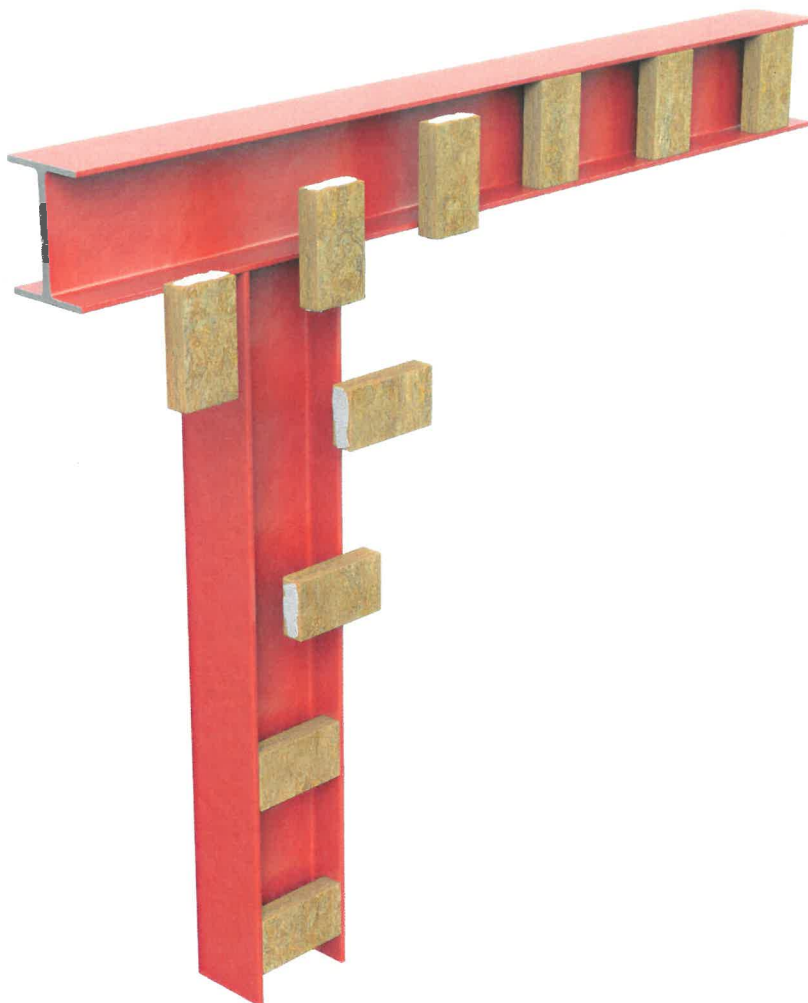
Рис. 2 Вклейка вставок в распор полок
